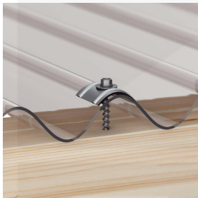
Bevestiging op de berg met schroeven en kalotten (ca. 10 p/m 2 )*
