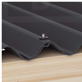
Overlappen worden altijd op de berg bevestigd (ca. 3 p/m 2 )
