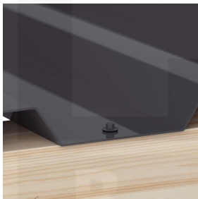
Optionale bevestiging in het dal met schroeven (ca. 6 p/m 2 )
