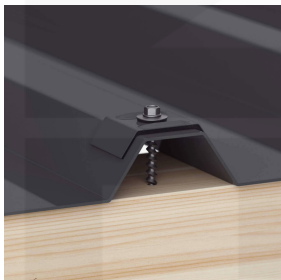
Aanbevolen: Bevestiging op de berg met kalotten en schroeven (ca. 6 p/m 2 )*
