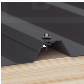
Overlappingsen worden altijd op de berg bevestigd (ca. 3 p/m 2 )*
