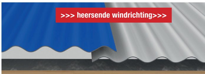
Doorsnee: voorbereiden van acrylaat lichtplaten
