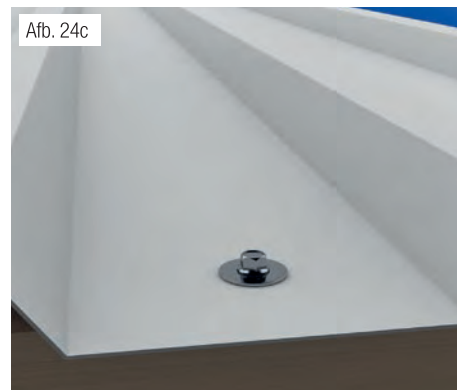
bevestigingsschroef met dichtring (E19 voor damwand / E12 voor golfplaat) in het profieldal
